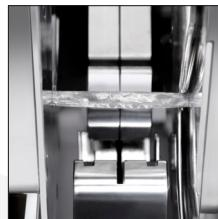
Клипсатор оснащён фаршевытеснителями, обеспечивающими производство колбас с чистыми хвостиками.
