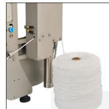
Alimentador cordel sarta para fabricar el embutido en formato herradura.
