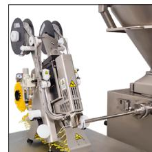
Агрегируется со шприцом, поршневым либо вакуумным.
